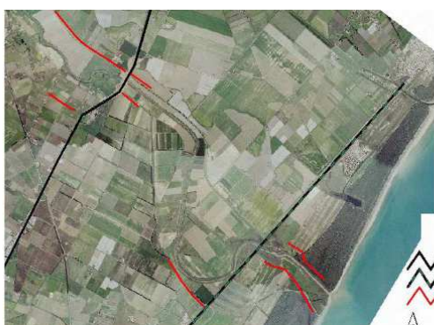
Risultati simulazione 1D: indicazione dei tratti d'alveo insufficienti al deflusso dell'evento di piena con T=30 anni
